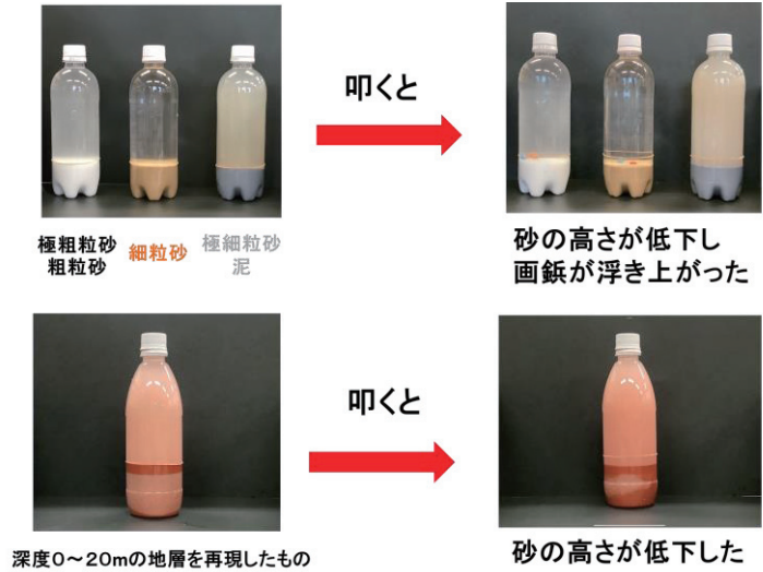
図4 液状化現象のモデル実験の結果
