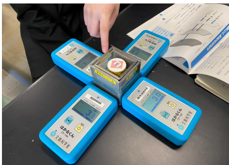
放射線測定器による遮蔽実験の様子
