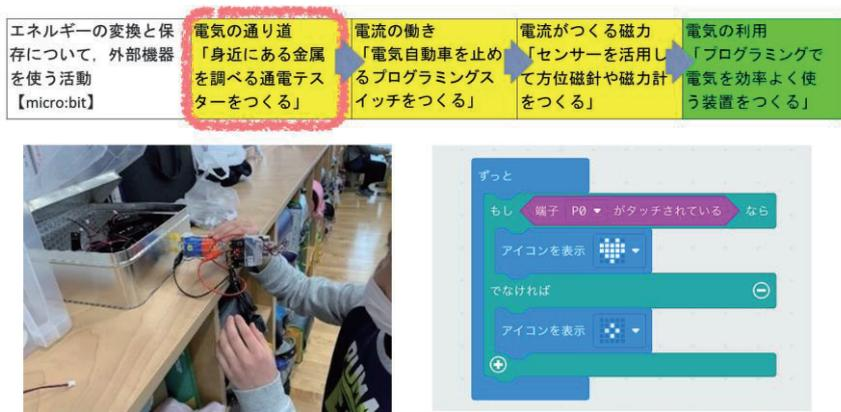
図1 【3年】通電テスター 回路の一部を micro:bit へ置き換え
