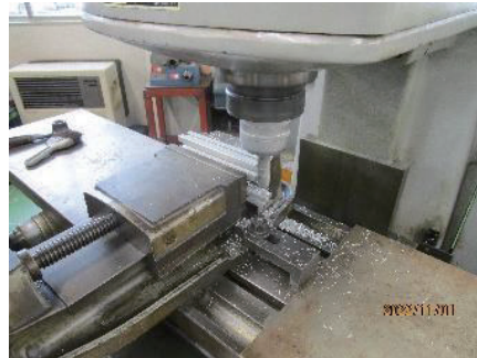
写真2 網取付部穴あけ
