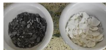
図 5 ホタテ貝殻の変化 (左：600°C焼成、右：800°C焼成)
