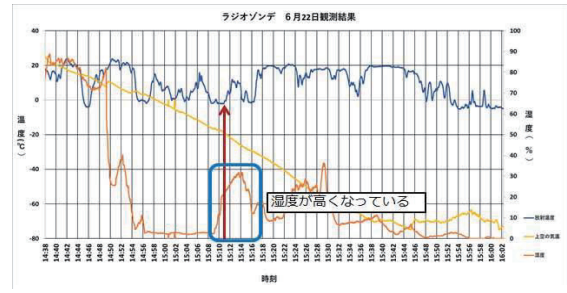
図 14 ラジオゾンデの結果(気温と湿度)と放射温度
