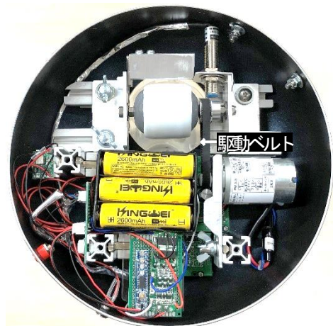
図1 バンデグラフ起電機の内部構造 (電池の裏にPWM制御器と回転計を設置)
