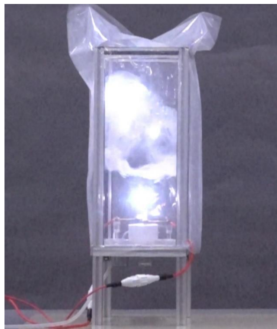
図8 Mg粉末ではわずか0.1gの試料で着火に成功
