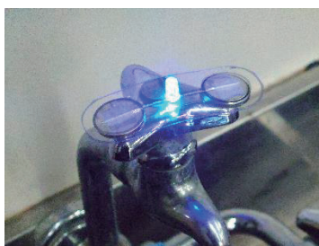
写真8 通電チェッカー
