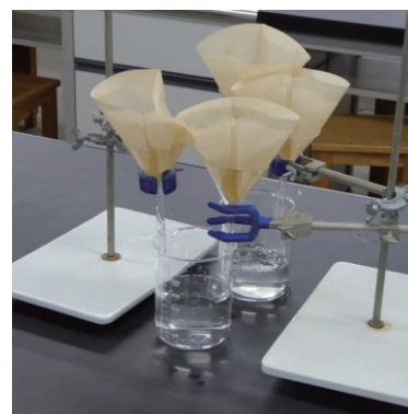
図3 コーヒーフィルターを使った濾過の様子
