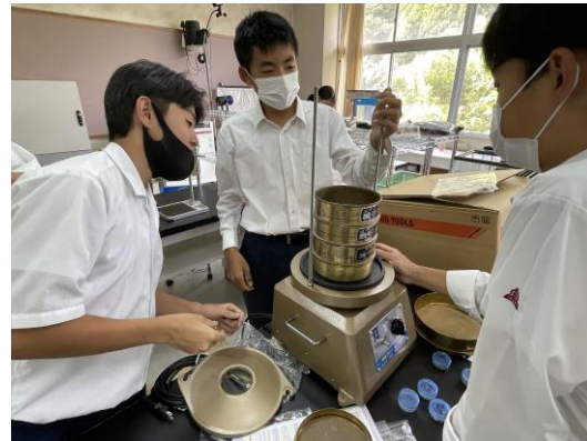
Fig.3 電動ふるいを用いた分離
