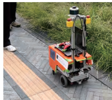
図.2 植生を誤検知して停止中
