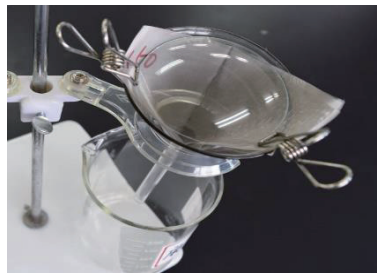
図4 金属メッシュ(150)によるろ過の様子
