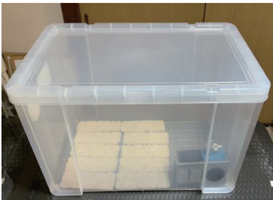
図-3 PM2.5 吸着試験用のポリプロピレン製容器と測定の様子 (左からblank, 活性炭 : 石膏 = 7:3 試料板, 100% 石膏板, 卵殻 : 石膏 = 7:3 試料板)
